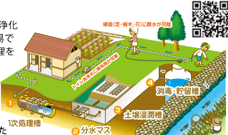
7 施工時期：2022年2月 システム：ソフィール循環、アメリオ 人 槽：80人槽 汚水量：1.2m3/日 発注者：東京都 小笠原支庁
