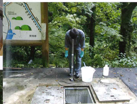
透視度の測定状況
